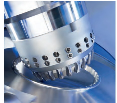
Figuur 4. Het rolsteken is een nieuw proces op het gebied van binnenvertandingen (foto: Klingelberg)
