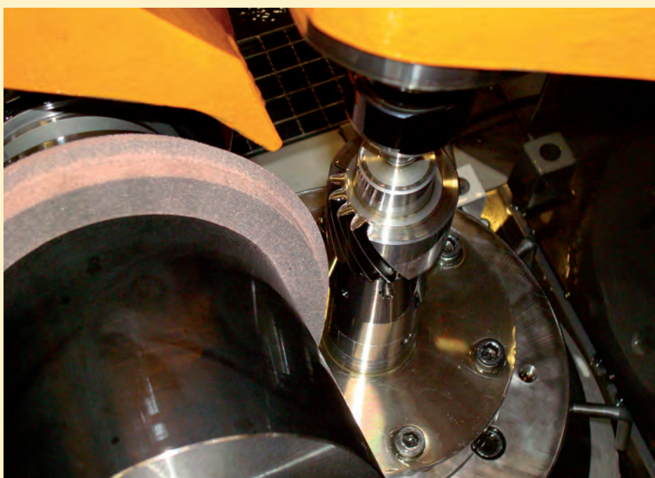
Figuur 1. Het slijpen van tandwielen uit volmateriaal zoals bij Van Eijk Transmissie is prima geschikt voor het snel leveren van prototype tandwielsets (foto: Van Eijk Transmissie)
