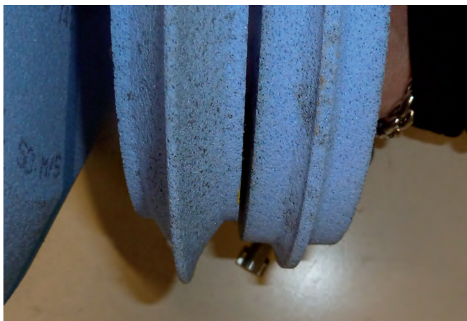
Figuur 2. De slijpstenen krijgen middels dressen de vorm van de tanden (foto: Paul Quaedvlieg)
