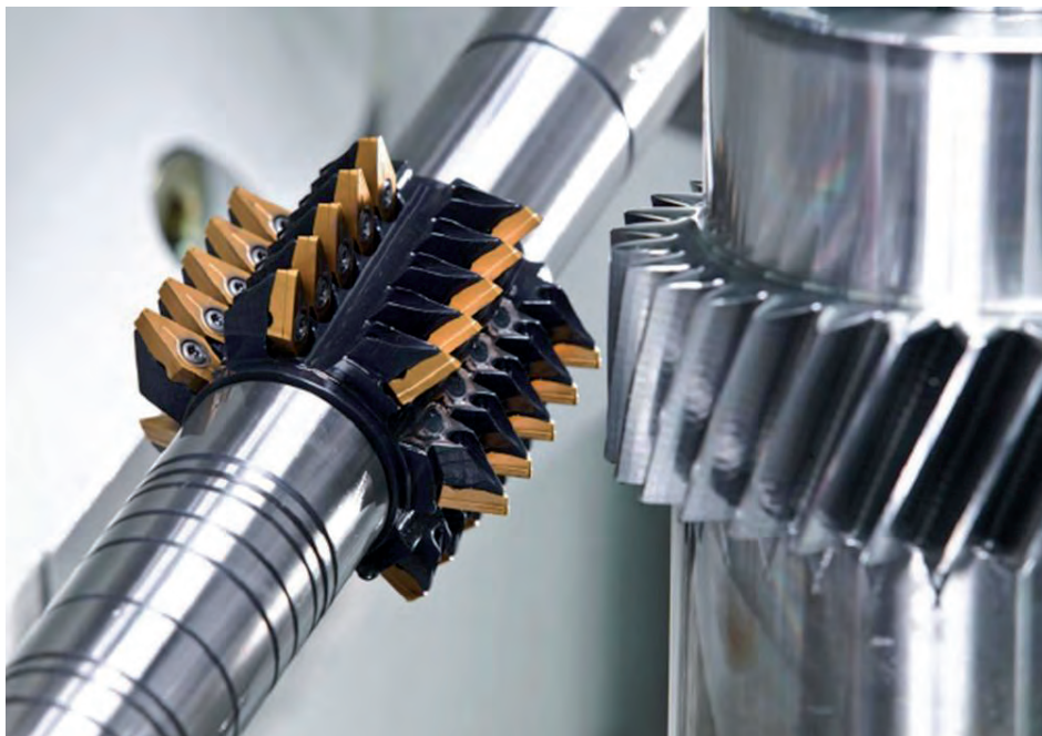
Figuur 7. De afwikkelfrees Coromill 176 freest efficiënt en snel vertandingen volgens DIN3972-2 (foto: Sandvik)
