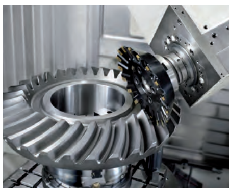
Figuur 8. Het maken van tandwielen via de uP-Gear technologie gaat vooral sneller ten opzichte van het vijfassig frezen met vingerfrezen (foto: Heller)
