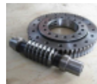
Zelf remmende wormoverbrenging
