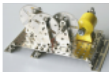
Cascade' tandwielen set voor zeer grote overbrengingen
